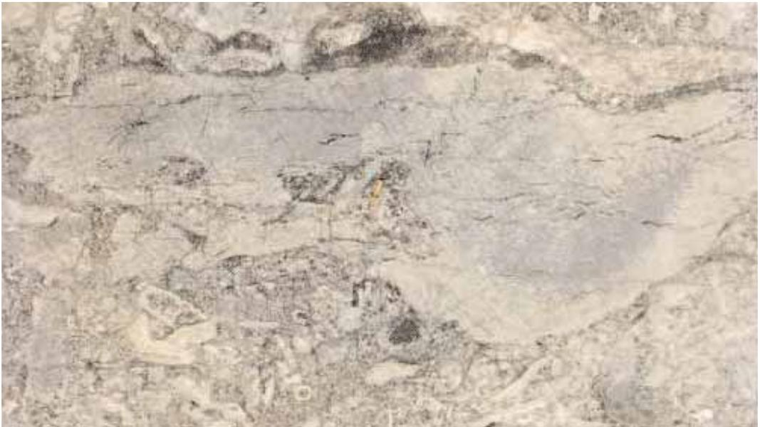
Fig. 5.8 - Calcari di mare basso di età devoniana media (Calcari di piattaforma, D<sub>4</sub>). Si possono definire "bioclastici" in quanto formati da frammenti di origine biogena (gusci, impalcature mineralizzate e altro tritume di origine organogena).
